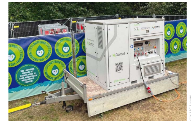
Der H 2 Genset, ein flexibler und mobiler Stromerzeuger mit Wasserstoff-Brennstoffzellen, kam auf dem Abifestival zum Einsatz.
