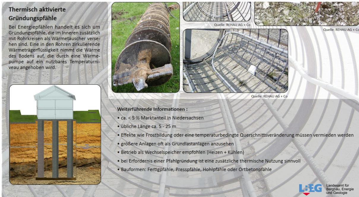
Abbildung 17 Fundamente mit integrierter Erdwärmenutzung
