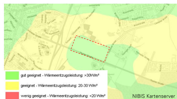
Abbildung 14 Wärmenutzleistung für den Einsatz von Erdwärmekollektoren
